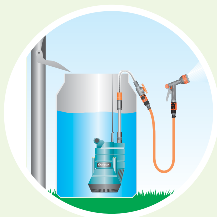
Zbiornik na deszczówkę
